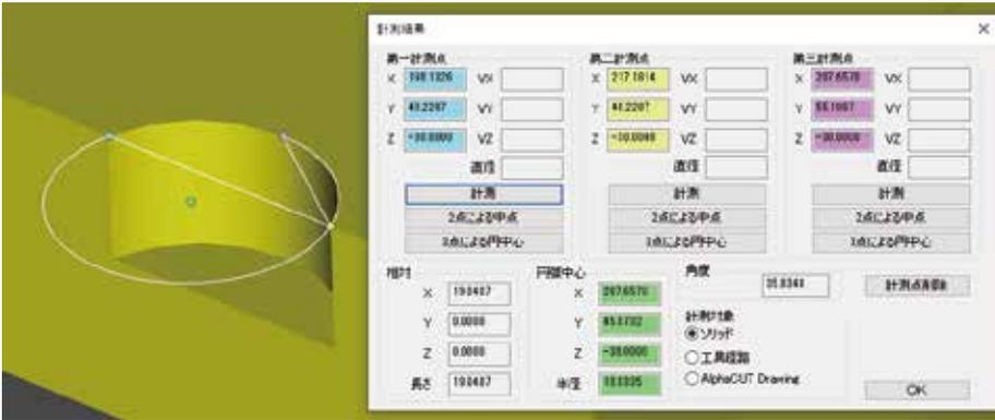
ソリッド、工具経路、形状線の距離を計測します。
