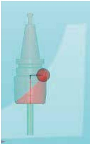
ホルダと素材の干渉図形を作成。工具先端と干渉位置までの長さを検出。
